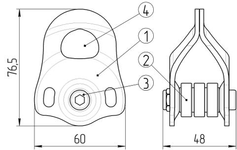
**Рис. 1.** 1 – щека; 2 – ролик;
