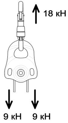
**Рис. 5.** Разрушающая нагрузка
