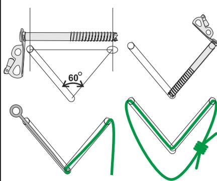
Рис. 6. Установка ледобура
