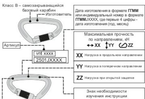
Рис. 2. Идентификация и маркировка изделия
