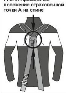
Рис. 9. Правильное положение страховочной точки А на спине
